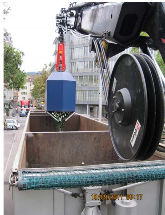
Abbildung 3: Entleerungen von Containern in das "Grünlas-Kompartiment" des Sammellastwagens. Auf dem linken Bild ist ein Unterflurcontainer zu sehen, auf dem rechten Bild ein Container des Typs "Ökowab".
