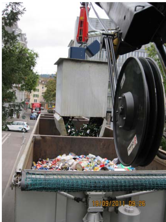
Abbildung 3: Entleerungen von Containern in das "Grünlas-Kompartiment" des Sammellastwagens. Auf dem linken Bild ist ein Unterflurcontainer zu sehen, auf dem rechten Bild ein Container des Typs "Ökowab".
