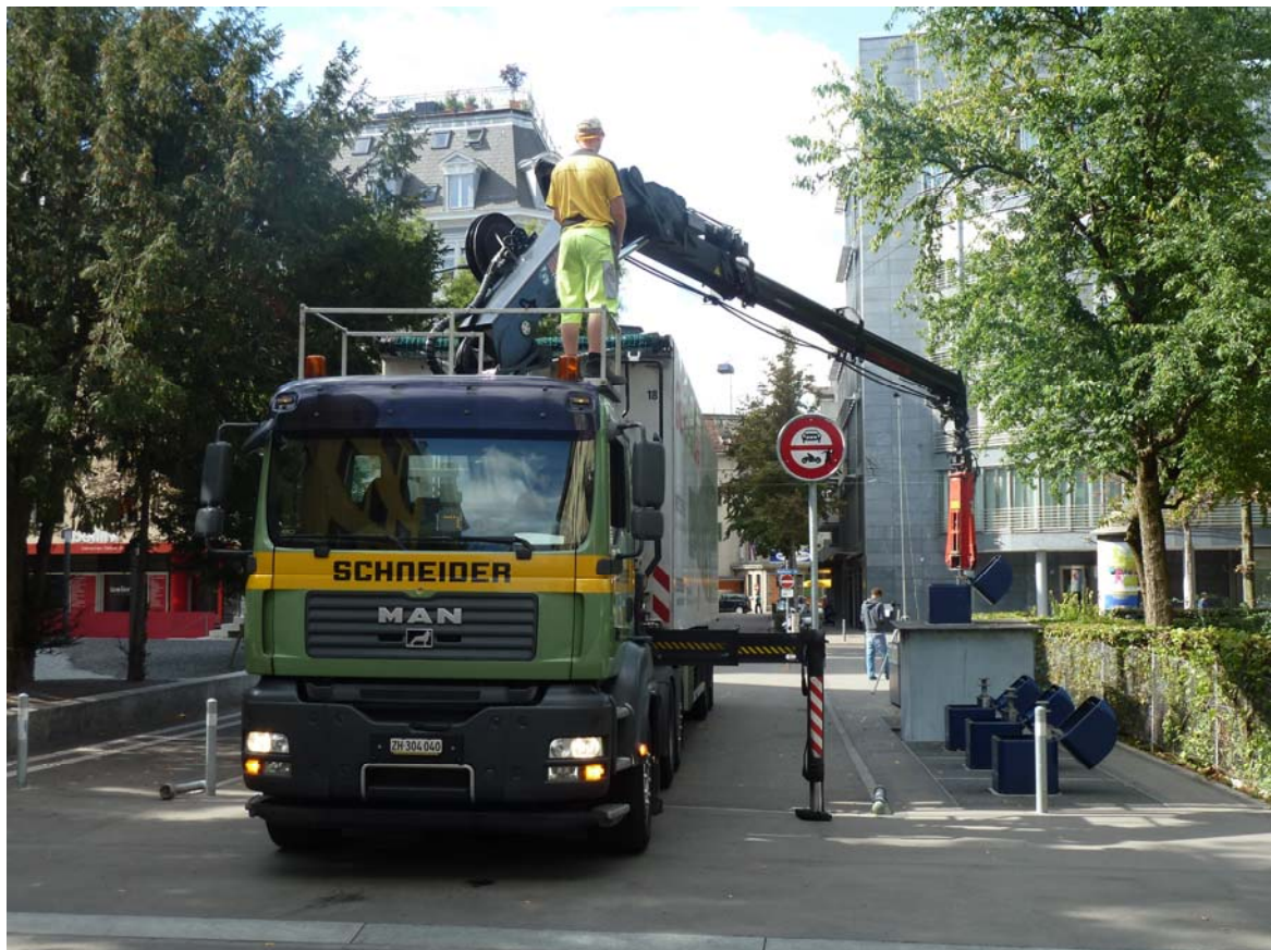
Abbildung 2: Anheben eines Unterflurcontainers bei der Entleerung in ein Sammelfahrzeug.
