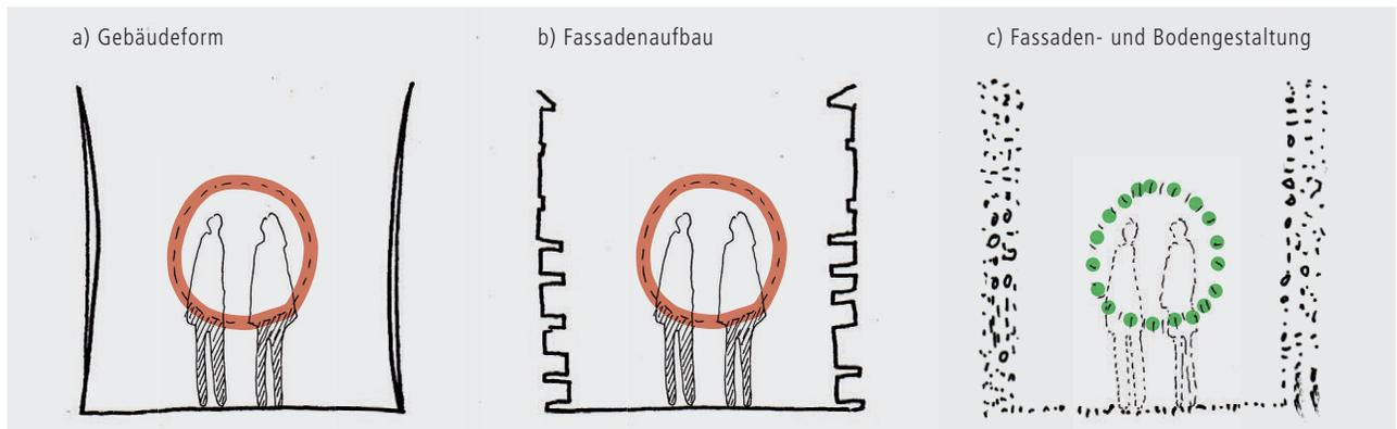
Figur 9 Möglichkeiten der akustischen Profilierung bei Fassaden
