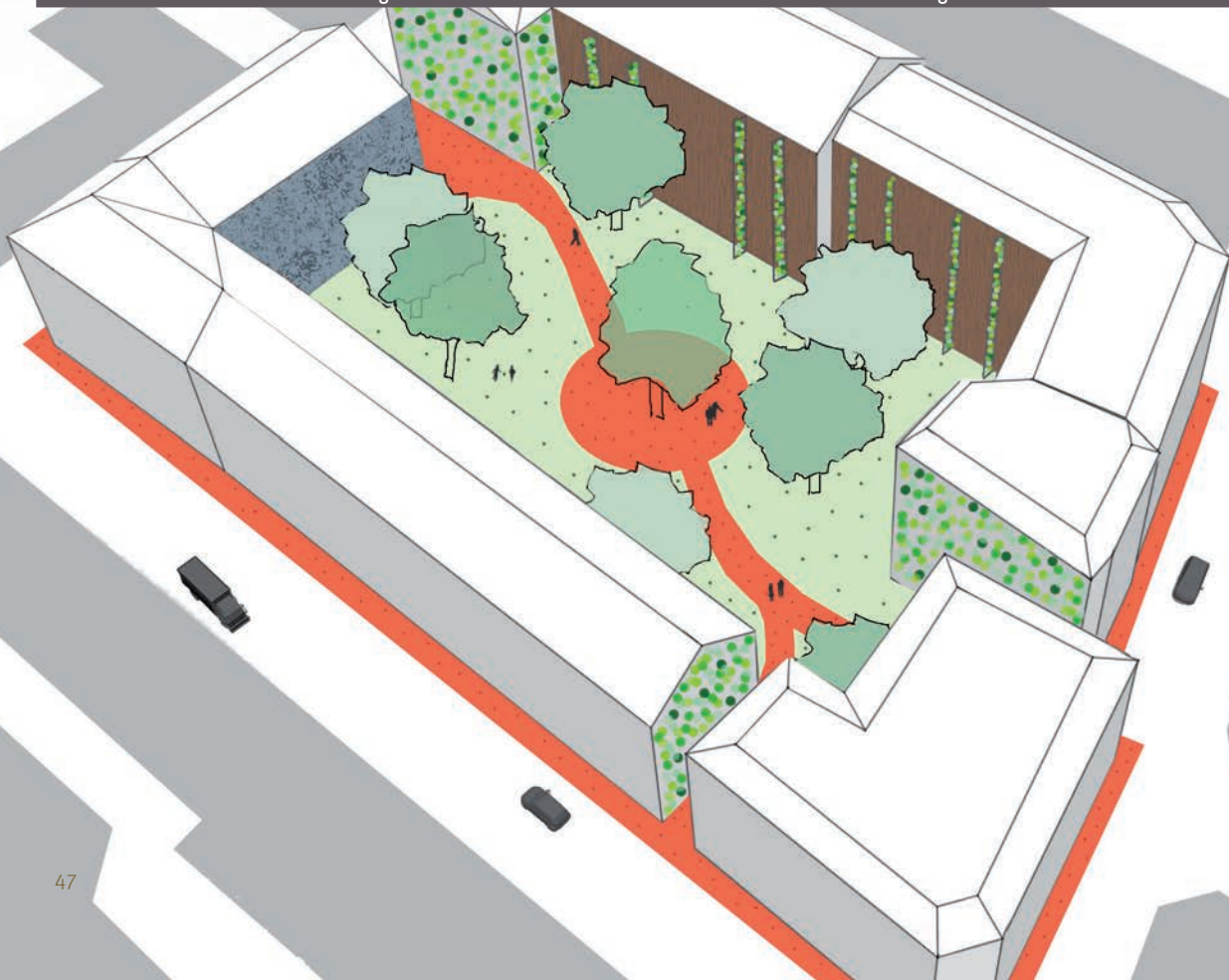
FIGUR 40 Der Innenhof ist über drei Zugänge erschlossen, die den Bezug zur Stadt aufrechterhalten. Die Fassaden an den Zugängen sind gebäudehoch begrünt. Die Hoffassaden werden mit vertikalen Gestaltungselementen entlang der Balkone gegliedert. Sie verändern die akustischen Eigenschaften der Wand und variieren so die Reflexionswege zwischen den Gebäuden.
