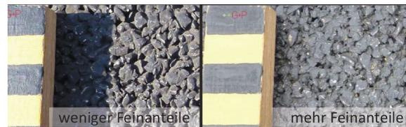
**Abb. 3:** Zwei semidichte Beläge mit gleichem Grösstkorndurchmesser und Hohlraumanteil (SDA 4-12) aber unterschiedlichen Feinanteilen (Quelle: G+P)
