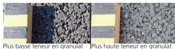
**Fig.3:** Deux revêtements semi denses avec le même diamètre du grain et le même nombre de cavités mais des granules différentes (Source : G + P).
