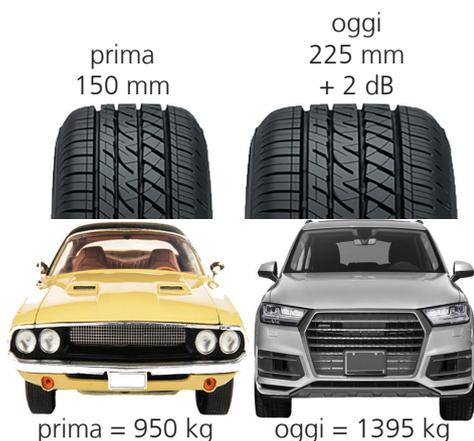
Fig.1: Dimensioni dei pneumatici e peso a vuoto di un'autovettura standard del passato e del presente.
