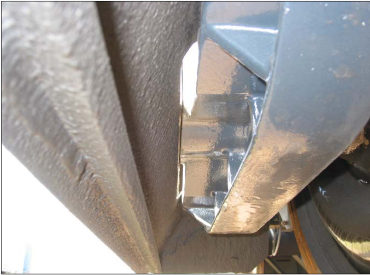
Abb. 28: Schallschürze mit Entdröhnungsmaterial
