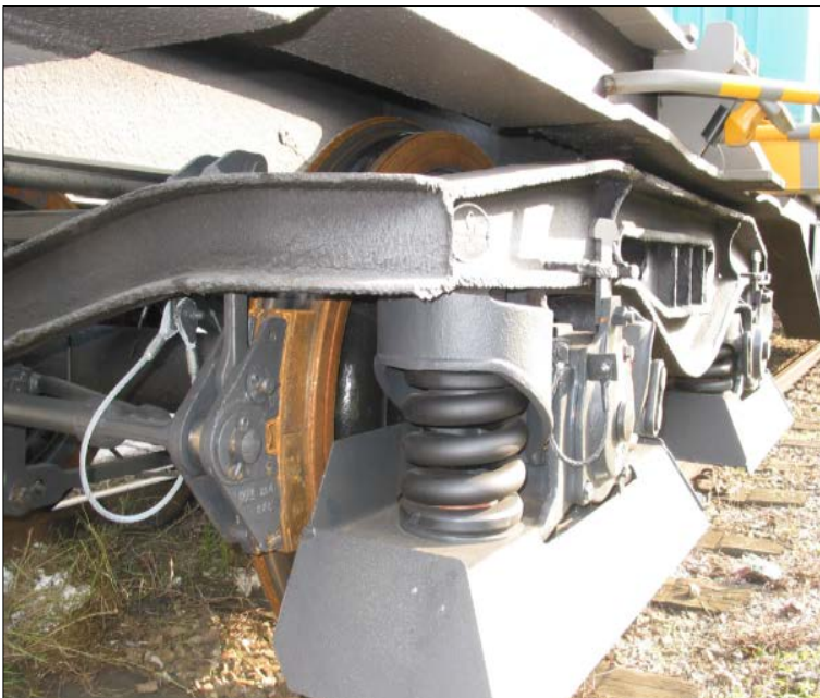
Abb. 27: Schallschürze am Radsatz
