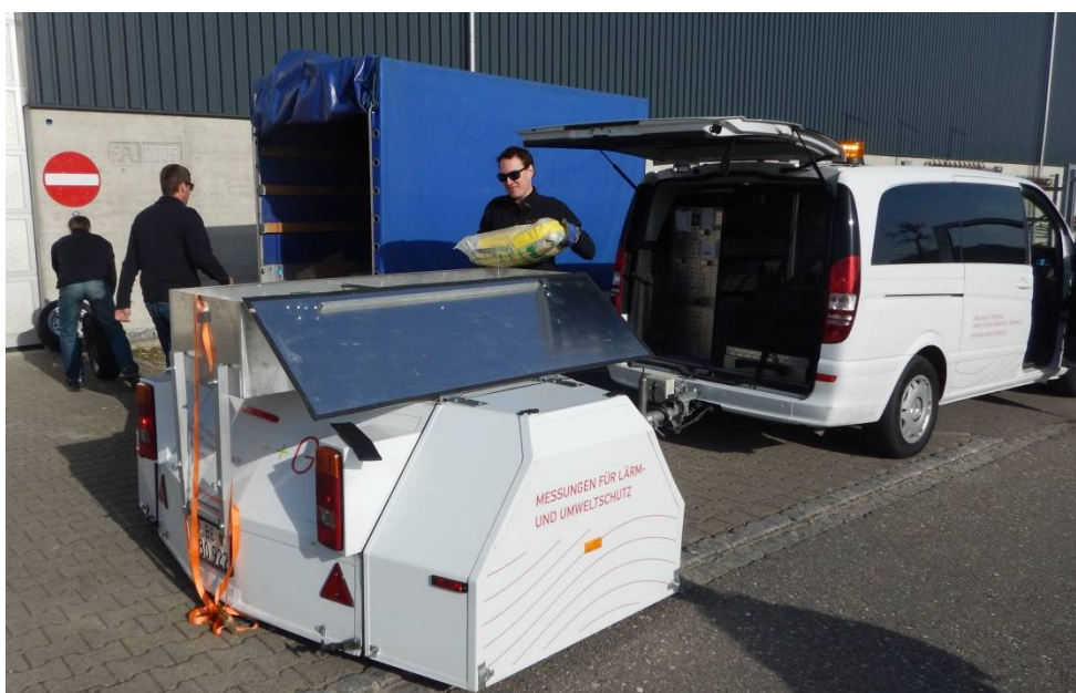
Abbildung 16: Beladen der Gewichte auf der Vorrichtung des CPX-Anhängers.
