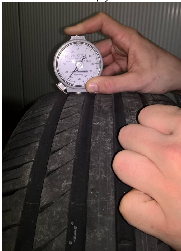
Abbildung 13: Shore A (Gummihärte) Messungen.
