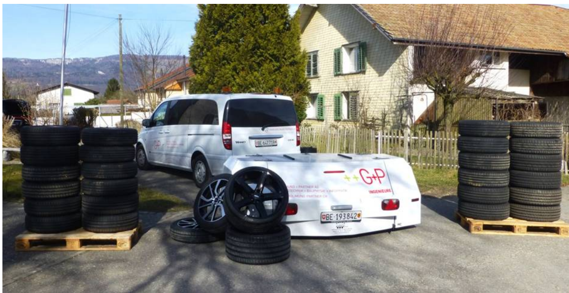
Abbildung 1: Alle in diesem Projekt verwendeten Testreifen mit dem CPX-Messfahrzeug von Grolimund + Partner AG.
