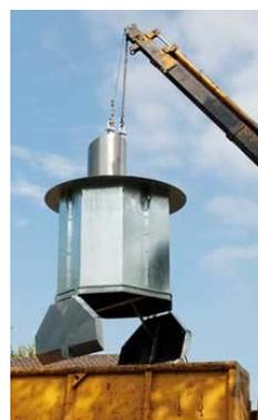
Abbildung 10: Entleeren Unterflurcontainer
