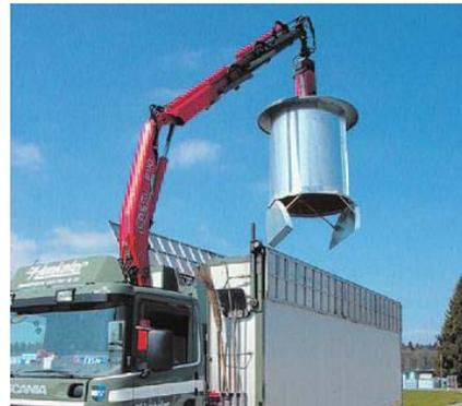
Abbildung 8: Entleerung Halbunterflursystem
