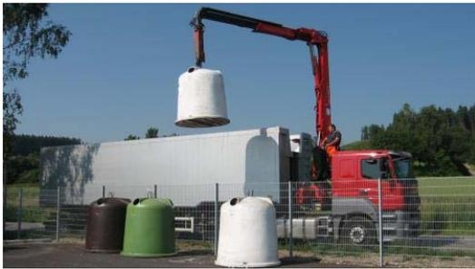
Abbildung 4: Entleerung mobiler Sammelcontainer (<http://www.locally.de/print/14457>)
