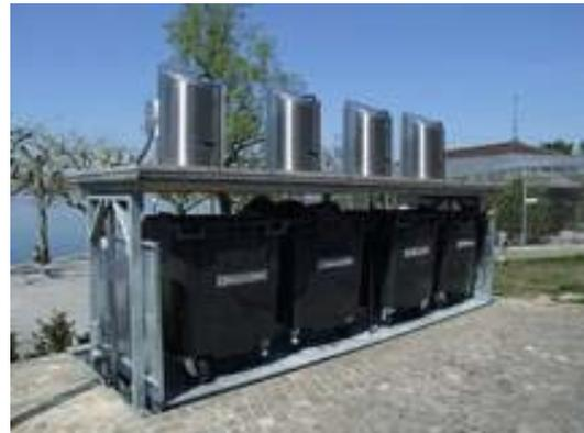
Abbildung 12: Unterflursystem auf hydraulischer Plattform mit Einzelcontainer
